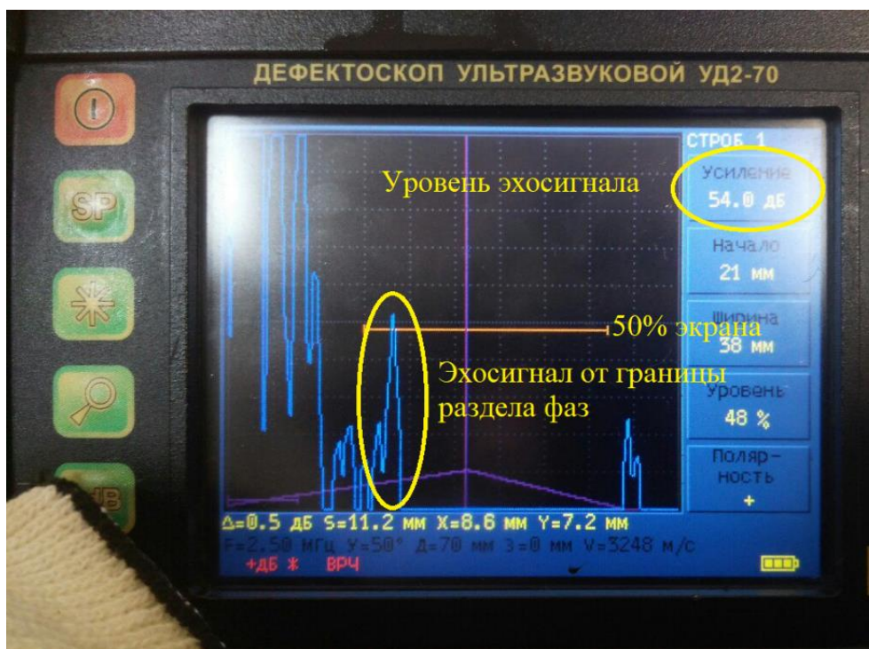
Рисунок 2 – Эхосигнал от границы раздела фаз и его уровень
