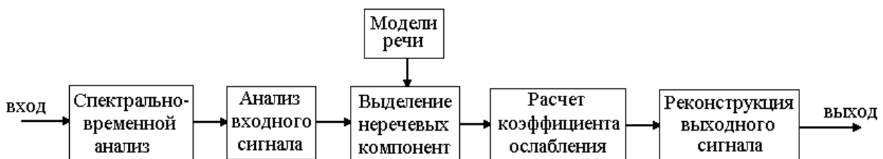
Рис. 3. Иллюстрация принципа работы алгоритма SoundSmoothing
