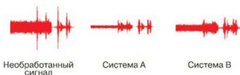
Рис. 1. Работа систем шумоподавления, основанных на модуляции
